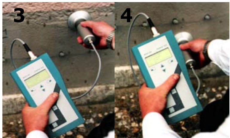
Nach der Injektage: Mauerfeuchte 3% Meßpunkt 2- oberhalb der Sperre
