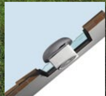
Einbau in schräge Scheiben oder Fenster (0-90°) mit Dachhaube DH
